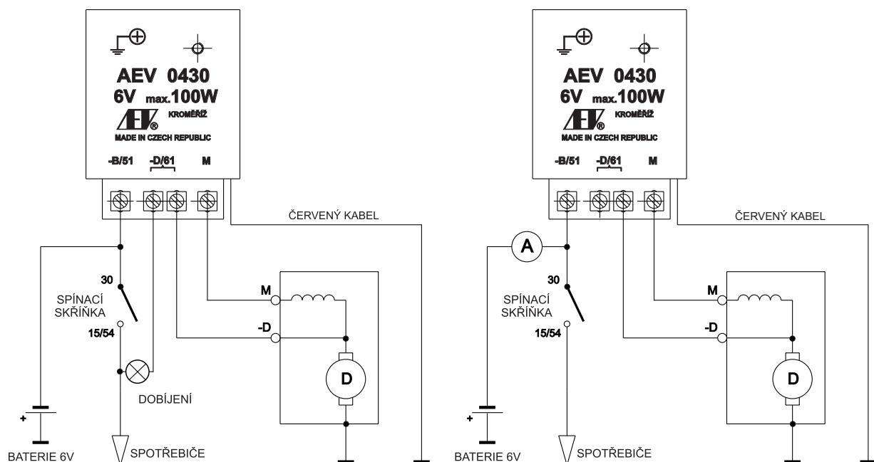
Aplikační schéma uvádí základní zapojení regulátoru a dynama do elektrické instalace vozidla. Při aplikaci regulátoru je nutné brát na vědomí, že regulátor není chráněný proti přepolování a v síti vozidla musí být vždy zapojený akumulátor s plusovým pólem na kostře.
